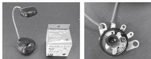
図1 可変抵抗を利用した電気器具
